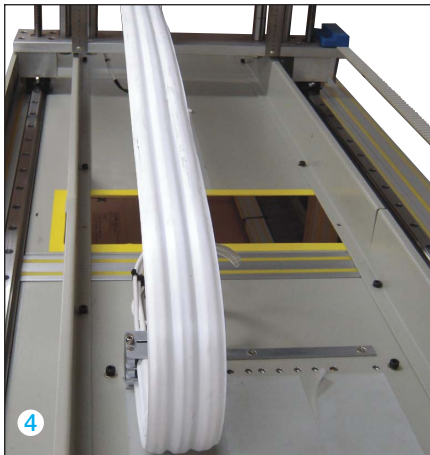
4. 移動端及び固定端クランプ部が仮止めされた状態で、移動端を往復移動させ、動作を確認します。 (写真 4、5)
