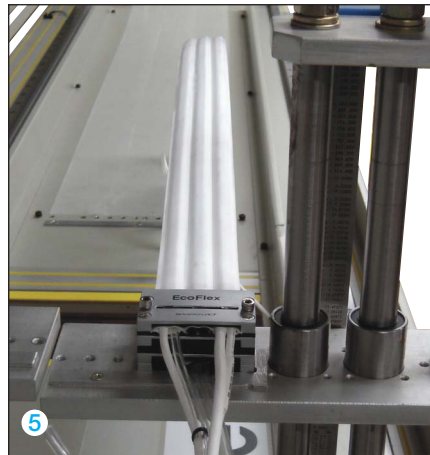
5. クリーンベヤ本体が正しく動作することを確認したのち、移動端、固定端部を固定します。 ※クリーンベヤ本体がねじれている場合は、移動端あるいは固定端クランプ部の位置調整によりねじれをなくしてください。
