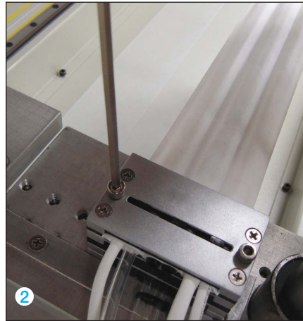
2. 移動端クランプ部を仮止めします。
